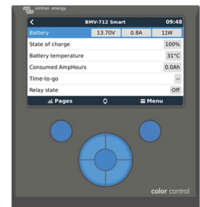
Color Control Den kraftfulla Linux-datorn, gömd bakom färgdisplaysen och knappar, samlar in data från alla Victron-utrustningar och visar dem på skärmen. Förutom att kommunicera med Victron-utrustningar kommunicerar Color Control via CAN-bus (NMEA2000), Ethernet och USB. Data kan lagras och analyseras på VRM-portalen.
